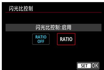
使用兼容闪光灯功能设置的微距闪光灯(MR-14EX II等)，可以设定闪光灯管或闪光灯头A和B之间的闪光比或使用附加的接收器单元进行无线闪光。
