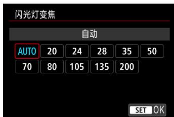
使用具有变焦闪光灯头的闪光灯时，可以设定闪光覆盖范围。通常，将该项设为[AUTO]，这样相机就会自动设定适合镜头焦距的闪光覆盖范围。
