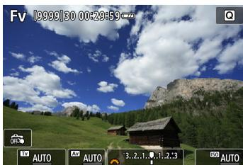
2 设定快门速度、光圈值和ISO感光度。
