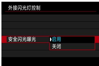
为避免白天期间闪光灯闪光或近距离闪光灯闪光时产生的曝光过度，当设定为ISO自动时相机可自动降低ISO感光度并使用标准被摄体曝光进行拍摄。
