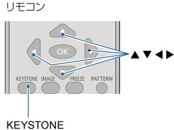
H/Vキーストーン ..... 投写映像の上下、または左右方向の長さ（ひずみ）を個別に調整します。
