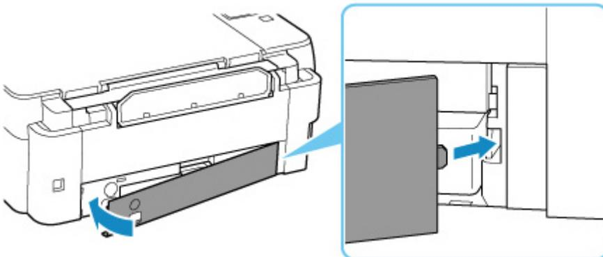
9. Insérez la vis dans le trou tournez-la dans le sens des aiguilles d'une montre pour la fixer.
