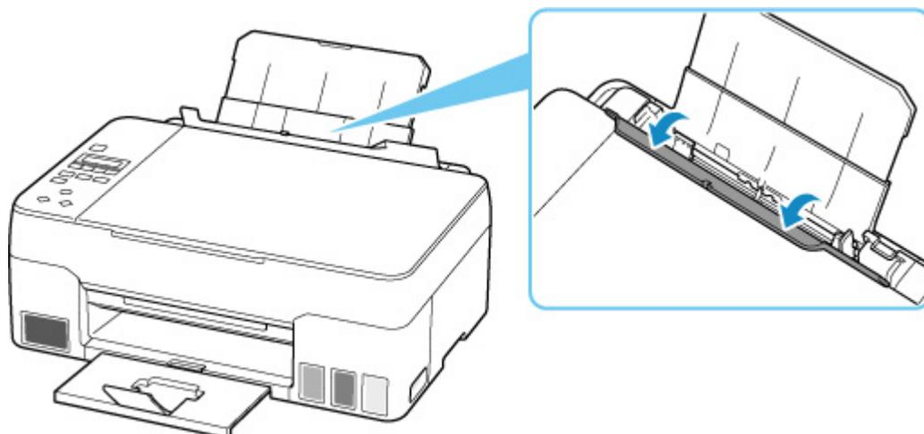
3. Pliez une feuille A4 en deux et insérez-la horizontalement dans le réceptacle arrière.
