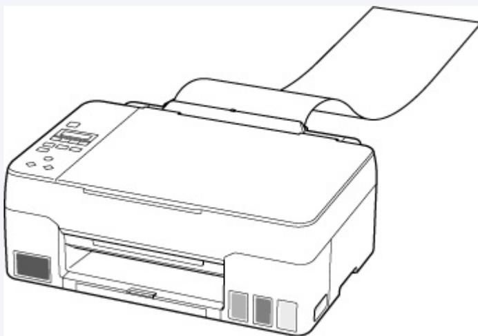
3. Déployez le bac de sortie papier (B) et l'extension du bac de sortie papier (C).
