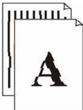
Les lignes sont mal alignées/déformées
