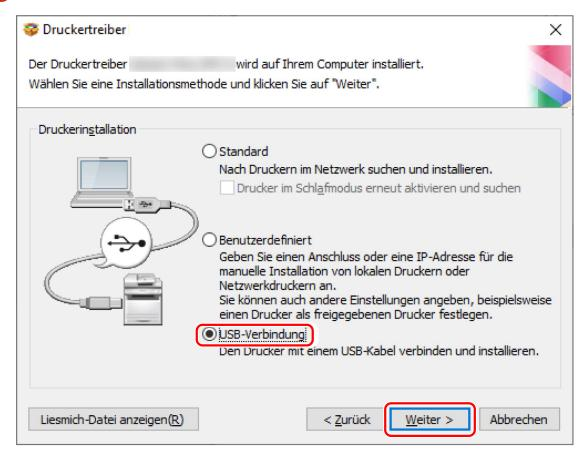
6 Wenn der folgende Bildschirm angezeigt wird, schließen Sie das Gerät über ein USB-Kabel an den Computer an → schalten Sie das Gerät ein.
