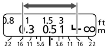
ピントを合わせた被写体の前後で鮮明に写る一定の範囲を被写界深度といいます。被写界深度の範囲は距離目盛下部の被写界深度目盛ではさまれた範囲となります。目盛上の数値はF値を示しており、例えば撮影距離が0.5mで絞りF16の場合は、約0.3mから無限遠までが鮮明に写る範囲となります。
