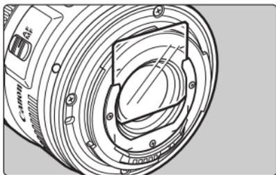
このレンズには、後部にゼラチンフィルターホルダーが設けられています。表示白枠内に入る大きさにフィルターを切り、フィルターホルダーに差し込んでください。
