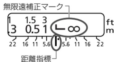
温度変化によるピント移動を補正するため、無限遠(∞)位置に余裕を持たせてあります。
