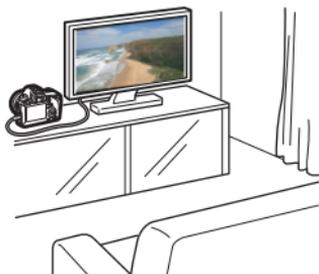
Utilice el cable AV que se proporciona o un cable HDMI HTC-100 (se vende por separado) para conectar la cámara a un televisor. Así podrá reproducir en el televisor los vídeos y las fotos que haya captado.
