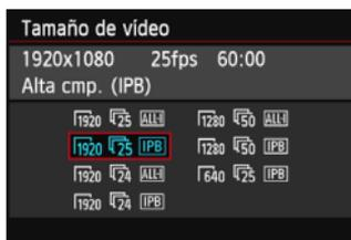
Con [**2: Tamaño de vídeo**], puede ajustar el tamaño de imagen del vídeo, la frecuencia de fotogramas por segundo y el método de compresión. La frecuencia de fotogramas cambia automáticamente en función del ajuste de [**3: Sistema vídeo**].
