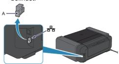
2. Verbinden Sie den Drucker und ein Netzwerkgerät (Router usw.) mit einem Ethernet-Kabel (A). Schließen Sie es nicht an den USB-Anschluss an.
