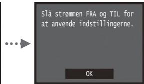
Sluk maskinen, og vent mindst 10 sekunder, før du tænder den igen. Telefonlinjetyperne registreres ikke automatisk. Se i e-Manual, og indstil en telefonlinje manuelt.
