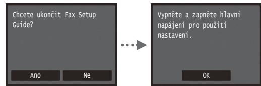
Vypněte zařízení a před jeho opětovným zapnutím počkejte nejméně 10 sekund. Typy telefonních linek nejsou automaticky rozpoznány. Podívejte se do dokumentu Elektronická příručka a nastavte telefonní linku ručně.
