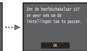
Schakel het apparaat uit en wacht minimaal 10 seconden voordat u het weer inschakelt. Het type van de telefoonlijn wordt niet automatisch vastgesteld. Raadpleeg de e-Handleiding en stel handmatig een telefoonlijn in.
