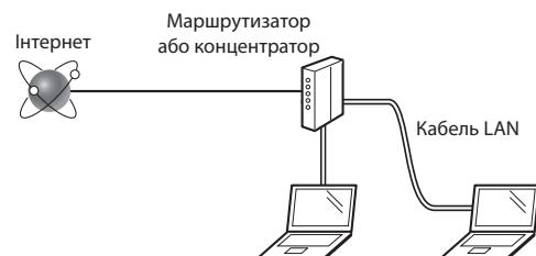
Чи комп’ютер і маршрутизатор (або концентратор) належним чином підключено за допомогою кабелю LAN?
