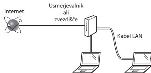
Ali sta računalnik in usmerjevalnik (ali zvezdišče) pravilno povezana prek kabla LAN?
