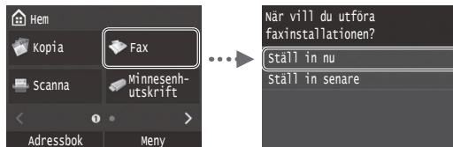
Följ anvisningarna i "Vägledning för faxinstallation" när du ska ange ett faxnummer, ett enhetsnamn och ett mottagningsläge. Mer information om mottagningsläget finns i e-handboken.
