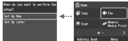
برای تعیین شماره فاکس، نام واحد و حالت دریافت، "راهنمای تنظیم فاکس" را دنبال کنید. برای اطلاع از جزئیات بیشتر درباره حالت دریافت، به دفترچه راهنمای الکترونیکی (e-Manual) مراجعه کنید.
