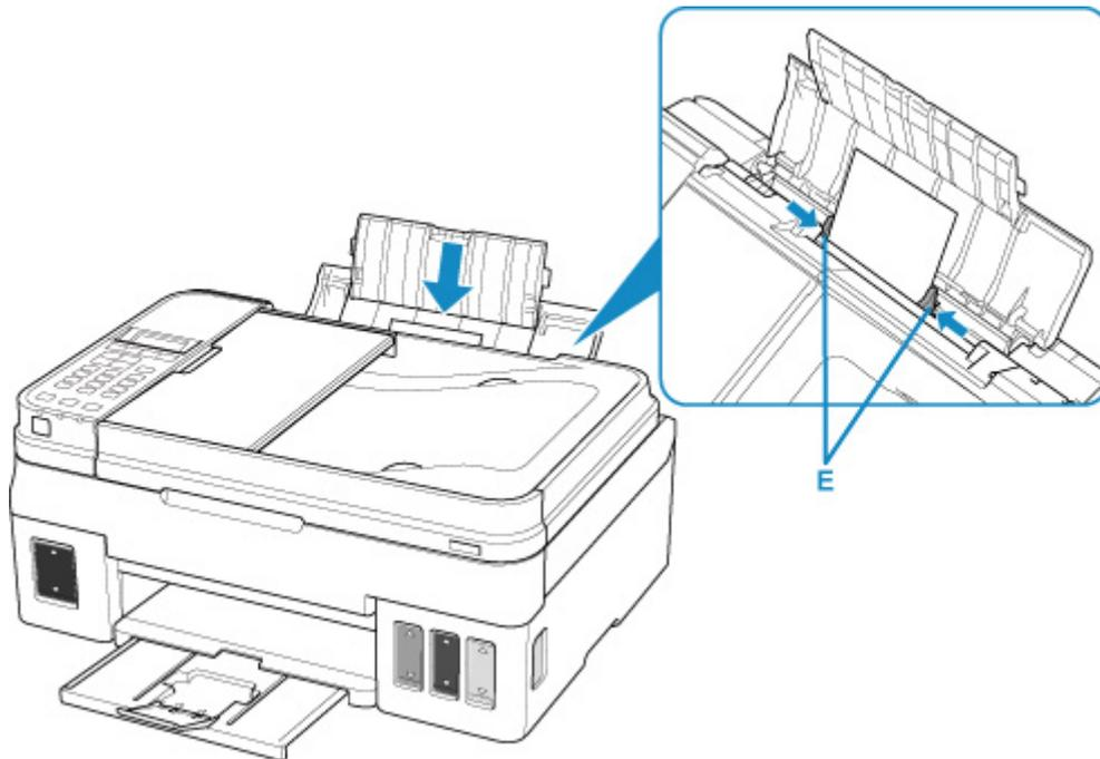
Después de cargar el papel en la bandeja posterior, la pantalla de registro de información del papel para la bandeja posterior se muestra en la pantalla LCD.
