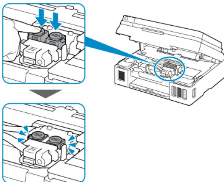
8. Cierre las dos cubiertas del depósito de tinta.
