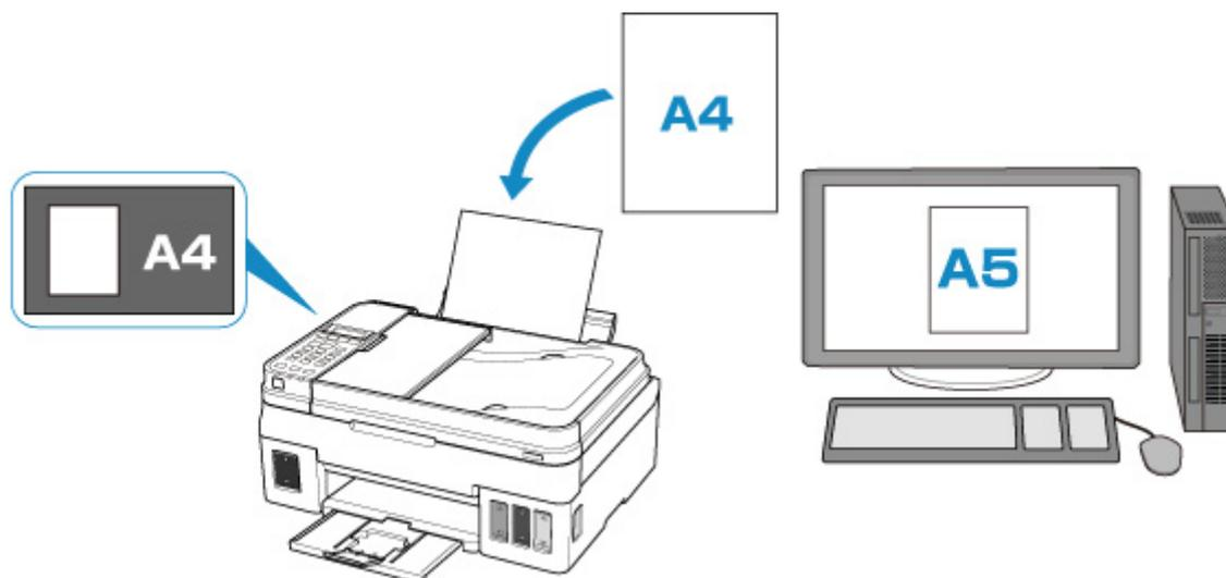
Cuando inicia la impresión o copia, aparece **Tamaño/tipo de papel cargado diferente del de config. impresión (The size/type of loaded paper is different from the print settings)** en la pantalla LCD.
