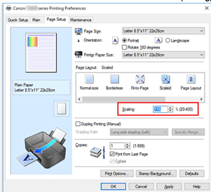
Los ajustes en uso se muestran en la vista preliminar de la configuración a la izquierda del controlador de impresora.
