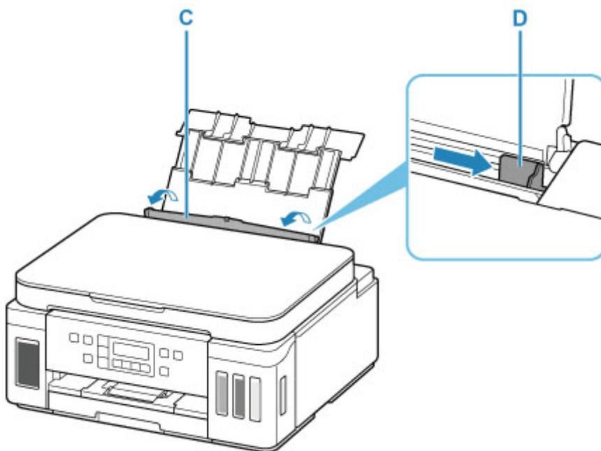
5. Cargue la pila de papel en orientación vertical CON LA CARA DE IMPRESIÓN HACIA ARRIBA.
