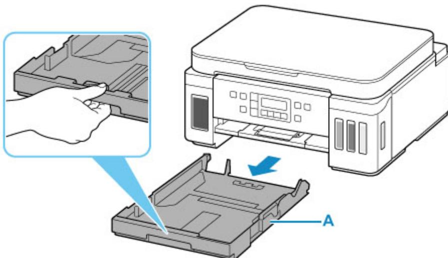
2. Deslice las guías del papel (B) al frente y (C) la derecha para abrir las guías.
