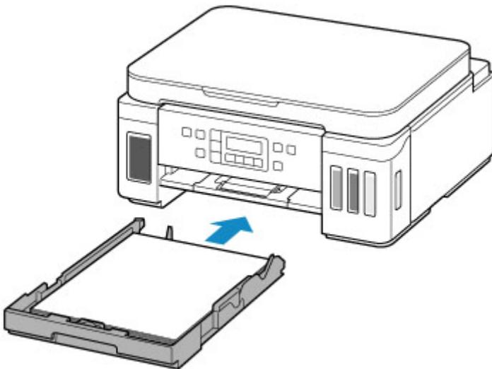
Después de insertar el cassette en la impresora, se muestra la pantalla de registro de información del papel para el cassette en la LCD.
