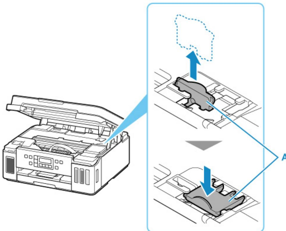
Coloque el tope del carro en la hendidura al lado de donde se insertó.
