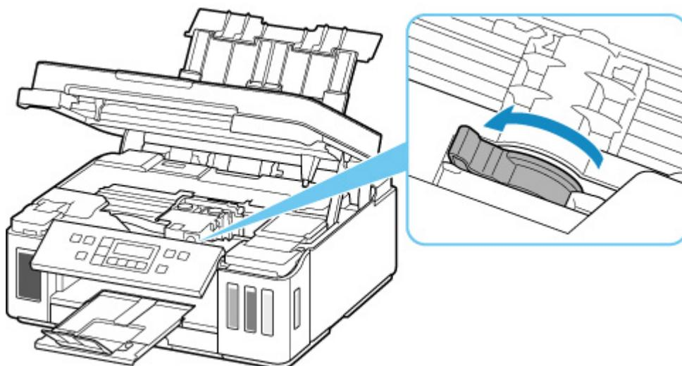
3. Agarre el botón (A) de la cubierta de bloqueo del cabezal de impresión para abrirla.
