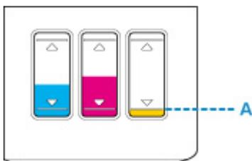
Si utiliza la impresora hasta que el depósito de tinta se vacía, realice la descarga de tinta tras rellenar el depósito de tinta.
