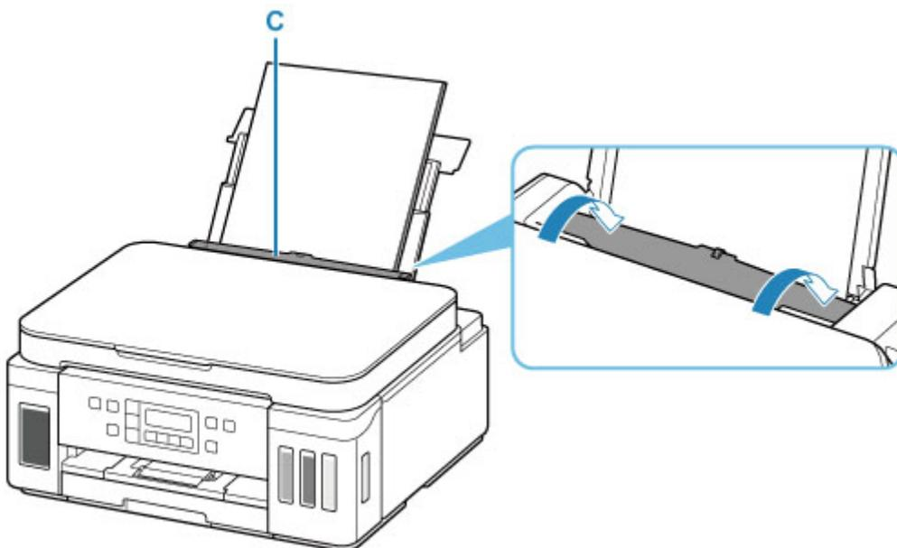
Después de cerrar la cubierta de la ranura de alimentación, la pantalla de registro de información del papel para la bandeja posterior se muestra en la pantalla LCD.
