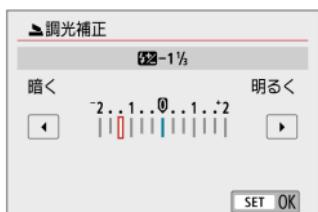
露出補正と同じ感覚で、ストロボの発光量を調整することができます (図248)。
