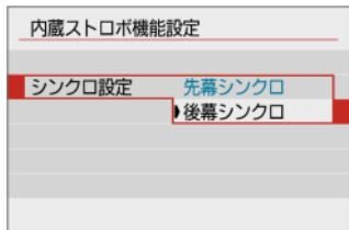
通常は、撮影開始直後にストロボが発光する【先幕シンクロ】に設定します。【後幕シンクロ】に設定すると、低速シャッター時に車のライトなどの軌跡を自然な感じで撮影できます。
