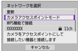
カメラアクセスポイントモードは、カメラと各機器を直接Wi-Fi接続する方法です。[Wi-Fi/Bluetooth接続] で、[□] [△] [凸] を選んだときに表示されます。
