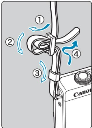
ストラップの先端をストラップ取り付け部の下から通し、さらにストラップに付いている留め具の内側を通します。留め具の部分のたるみを取り、引っ張っても留め具の部分がゆるまないことを確認してください。
