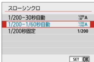
**[Av] 絞り優先AEモード、または [P] プログラムAEモードでストロボ撮影を行うときのストロボ同調シャッタースピードを設定することができます。**
