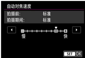
可以将自动对焦速度(对焦转变速度)从标准速度(0)调整为慢(七个等级之一)或快(两个等级之一), 以获得所需的短片创建效果。
