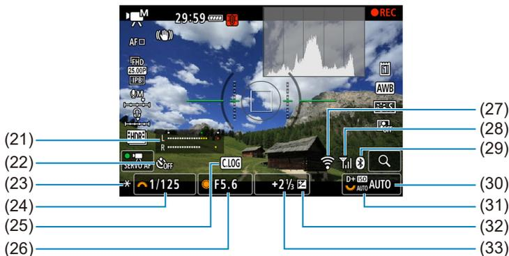
(21) 音频录音电平指示器(手动/线路输入)
