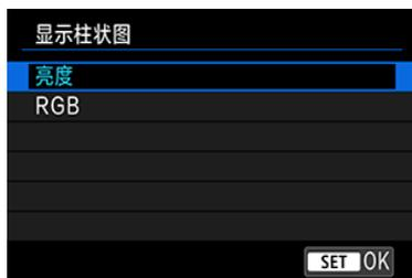
柱状图显示贯穿色调范围的信号量。可进行亮度显示(用于查看总体的曝光量和整体的色调层次)和RGB显示(用于查看红色、绿色与蓝色的饱和度色调层次)。在[▶]: **播放信息显示**屏幕的左下角中显示[INFO]时，通过按< INFO >按钮可以切换显示的柱状图。
