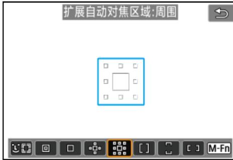
使用一个自动对焦点□和以蓝色轮廓包围的周围自动对焦点进行对焦，这比使用扩展自动对焦区域：☞对移动被摄体进行对焦更容易。伺服自动对焦操作与扩展自动对焦区域：☞的操作相同。
