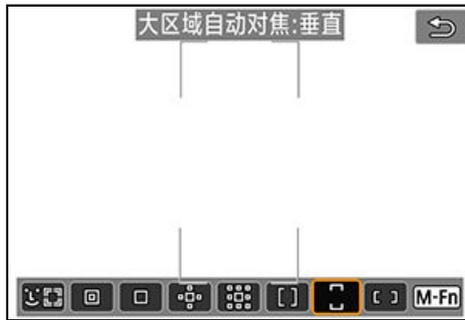
在垂直大区域自动对焦框中使用自动选择自动对焦可覆盖比区域自动对焦更广阔的区域，这比使用单点自动对焦/扩展自动对焦区域进行对焦更容易，且对移动被摄体也有效。确定对焦区域不仅基于最近的被摄体，也基于(人物或动物的)面部、被摄体移动和被摄体距离等其他多种条件。
