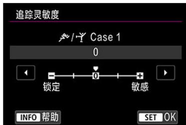
针对非被摄体横穿自动对焦点或被摄体偏离自动对焦点的伺服自动对焦的被摄体追踪灵敏度设定。
