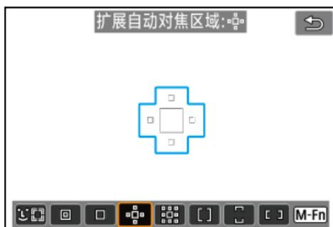
使用一个自动对焦点(□)和以蓝色轮廓包围的自动对焦点进行对焦。这对使用单点自动对焦进行追踪比较困难的移动被摄体比较有效。
