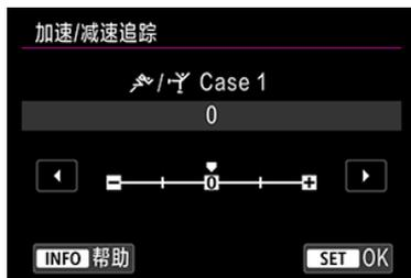
针对被摄体突然开始或停止移动等突然大幅改变速度的情况的人工智能伺服自动对焦/伺服自动对焦的追踪被摄体灵敏度设置。
