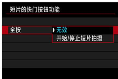
将[全按]设为[开始/停止短片拍摄]时，除了使用短片拍摄按钮外，还可以通过完全按下快门按钮或使用快门线TC-80N3(另售)来开始/停止短片记录。
