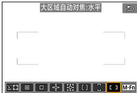
在水平大区域自动对焦框中使用自动选择自动对焦可覆盖比区域自动对焦更广阔的区域，这比使用单点自动对焦/扩展自动对焦区域进行对焦更容易，且对移动被摄体也有效。确定对焦区域不仅基于最近的被摄体，也基于(人物或动物的)面部、被摄体移动和被摄体距离等其他多种条件。
