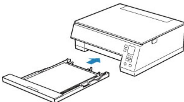
用紙のサイズが自動で検知され、プリンターに設定されます。
