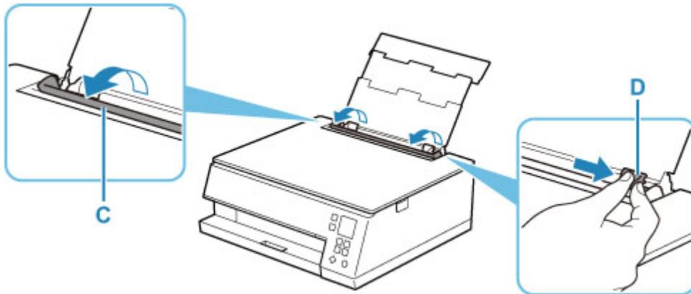
5. 印刷したい面を表にして、用紙を縦にセットする
