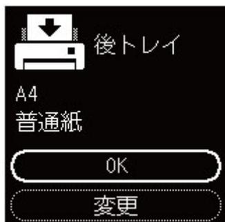
表示された用紙のサイズと種類が、後トレイにセットした用紙と同じであれば、[OK] を選びます。用紙のサイズや種類が異なるときは、[変更] を選び、セットした用紙に合わせて設定を変更します。
