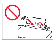
2 Öffnen Sie die Abdeckung für den Einzugsschacht und schieben Sie die rechte Papierführung ganz nach rechts.
