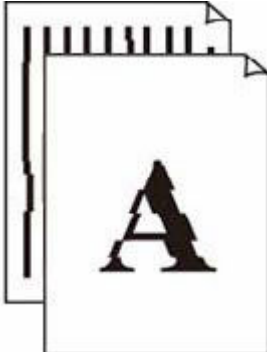
Las líneas no están alineadas/están distorsionadas
