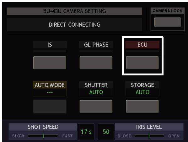
1 本製品とOP-450を接続し、OP-450の液晶ディスプレイ上にCAMERA SETTINGの画面を表示させる
