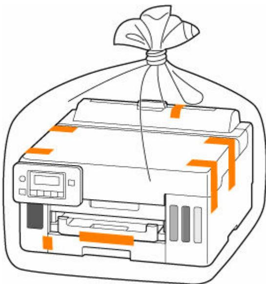
9. Coloque material de protección a ambos lados de la impresora cuando introduzca la impresora en la caja.
