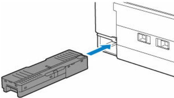
**7.** Coloque la tapa de mantenimiento.
