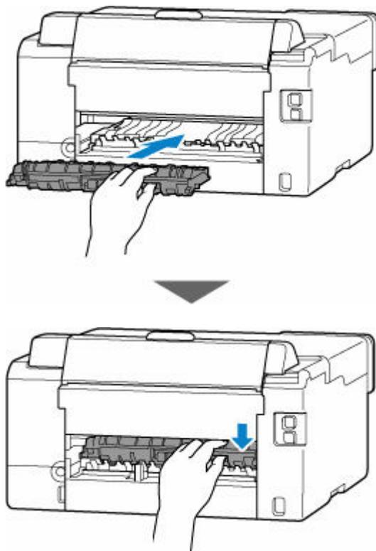
**7. Coloque la cubierta trasera.**
