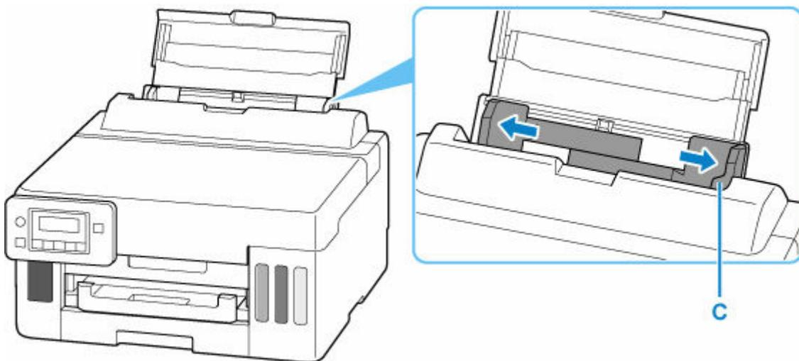
4. Cargue la pila de papel en orientación vertical CON LA CARA DE IMPRESIÓN HACIA ARRIBA.
