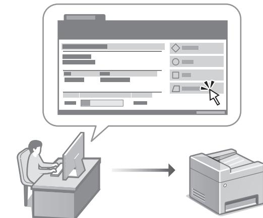
Con la IU remota, se puede gestionar este equipo desde un navegador web en un ordenador. Puede utilizarlo para consultar el estado operativo del equipo, cambiar ajustes y guardar elementos en la Libreta de direcciones.
