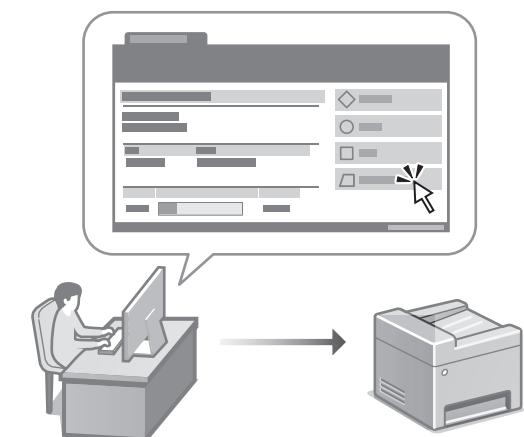
A Interface Remota permite que a máquina seja gerenciada usando um navegador da Web em um computador. Você pode usá-lo para verificar o status operacional da máquina, alterar configurações e salvar itens no catálogo de endereços.
