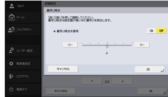
裏面に文字などがある薄い原稿をスキャンするときなど、裏面の模様が画像に写り込むようなときに、写り込んだ裏面の模様の画像を除去します。
