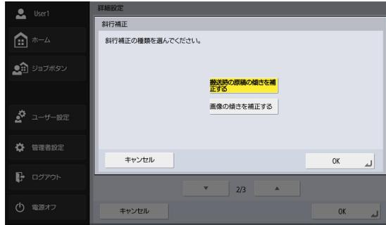
傾いた原稿の搬送をスキャンした画像で検知して、画像がまっすぐになるように補正します。
