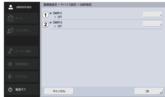
SNMPはMIBと呼ばれる管理情報データベースをもとに、ネットワーク上の通信機器を監視・制御するためのプロトコルで、PC を使って本機の状態やエラー情報などを確認することができます。本機はSNMPv1と、セキュリティ機能が強化されたSNMPv3に対応しており、いずれか一方を使用することも、両方を使用することもできます。使用目的や環境に合わせて設定してください。
