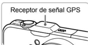
Es más fácil recibir una señal de satélite GPS si utiliza la cámara en espacios abiertos, donde el cielo es claramente visible. Asegúrese de que los dedos o cualquier otro objeto no bloqueen el receptor de señal GPS y diríjalo hacia el cielo; la recepción de la señal podría mejorar.
