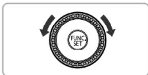
Al girar el dial de control se pueden realizar operaciones como seleccionar elementos o cambiar de imagen. Salvo por algunas excepciones, las mismas operaciones se pueden llevar a cabo con los botones ▲▼◀▶.
