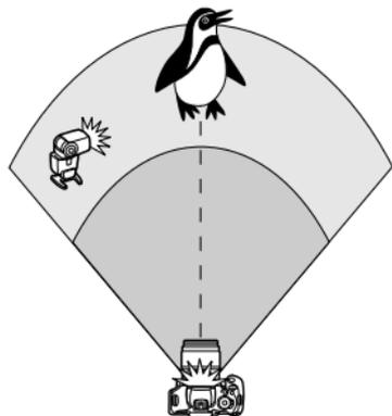
Aquí se describe el disparo de flash inalámbrico totalmente automático con un flash Speedlite externo y el flash incorporado.
