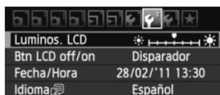
Bajo la ficha [📷], seleccione [**Luminos. LCD**] y, a continuación, presione <ⓈET>. Con la pantalla de ajuste visualizada, presione la tecla <◀▶> para ajustar la luminosidad y, a continuación, presione <ⓈET>.
