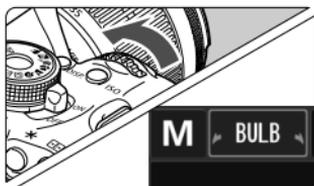
En la exposición "Bulb", el obturador se mantiene abierto mientras se mantenga presionado el disparador. Puede utilizarse para fotografiar fuegos artificiales, etc.
