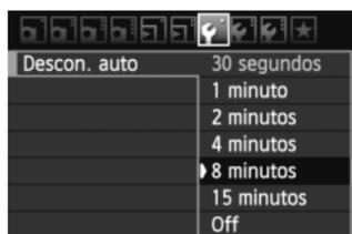
Bajo la ficha [📷], seleccione [**Descon. auto**] y, a continuación, presione <ⓈET>. Seleccione el ajuste que desee y, a continuación, presione <ⓈET>.
