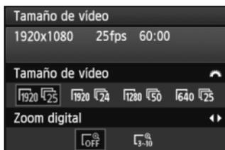
Bajo la ficha [📺], [Tamaño de vídeo] permite seleccionar el tamaño de imagen de vídeo [\*\*\*\*x\*\*\*\*] y la frecuencia de cuadros [FPS] (cuadros grabados por segundo). La frecuencia de cuadros FPS cambia automáticamente en función del ajuste de [📺 Sistema vídeo].
