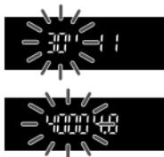
Si la fotografía va a ser demasiado oscura, parpadeará la indicación de velocidad de obturación de "30" (30 seg.). Si ocurre así, gire el dial
