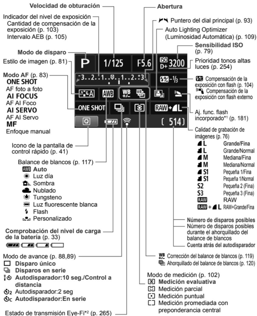
\*1: Se muestra cuando se levanta el flash incorporado.
