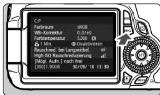
Wenn Sie die Taste **<INFO.>** drücken, während die Kamera aufnahmebereit ist, können Sie **[Zeigt Kameraeinstellungen]**, **[Zeigt Aufnahmeoptionen]** (S. 267) und **[Elektronische Wasserwaage]** (S. 127) anzeigen.
