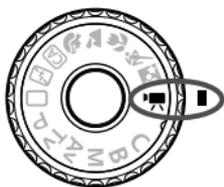
Stellen Sie das Modus-Wählrad zum Aufnehmen von Movies auf
