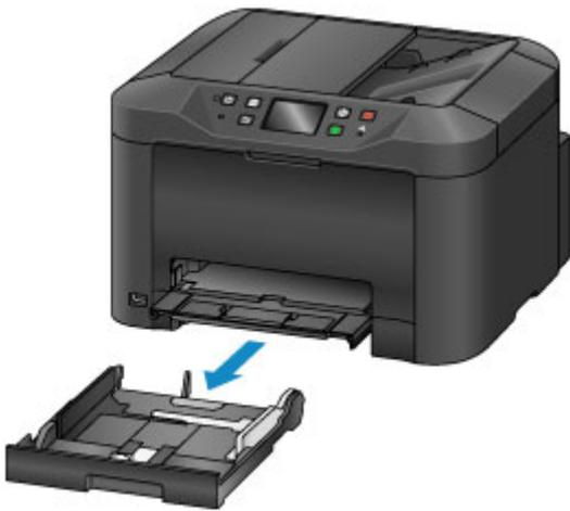
3. Deslice las guías del papel delantera (A) y derecha (B) hacia afuera para hacerle hueco al papel.
