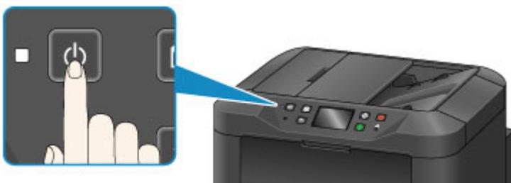
2. Compruebe que la luz de **ENCENDIDO (POWER)** está apagada.
