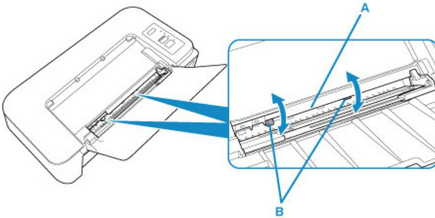
Après avoir nettoyé les rouleaux d'entraînement du papier, mettez la machine sous tension, puis nettoyez à nouveau les rouleaux d'entraînement du papier.
