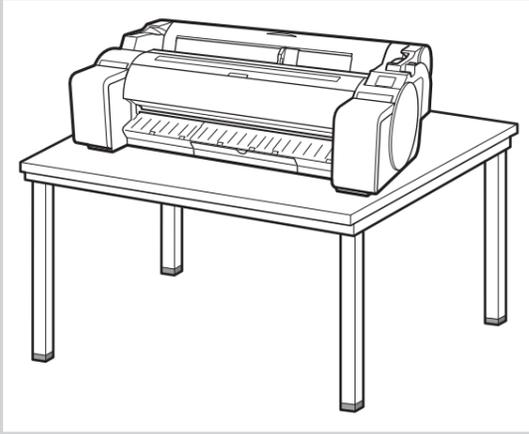
• Wenn Sie beim Tragen oder Absetzen des Druckers nur die Mitte des Druckers stützen, könnte dies den Drucker beschädigen.
