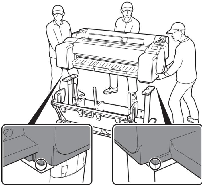
**5** Befestigen Sie den Drucker am Gestell. Sichern Sie den Drucker mithilfe eines Inbus-Schlüssels mit 2 M4-Sechskantschrauben an jeder Seite von der Unterseite der Stützplatte.
