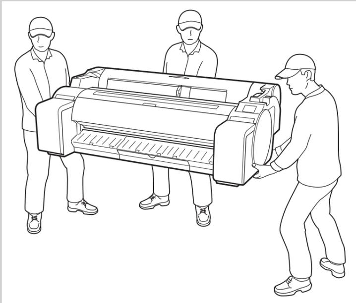
• Fassen Sie beim Transportieren des Druckers die Tragegriffe (A) unter jeder Seite und an der Rückseite fest an. Das Festhalten des Druckers an anderen Stellen ist gefährlich und kann Verletzungen und Schäden verursachen, wenn der Drucker fallengelassen wird.
