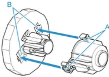
4. Setzen Sie die Papierspule für das Spulen des Rollenpapiers in den Rollenhalter ein.
