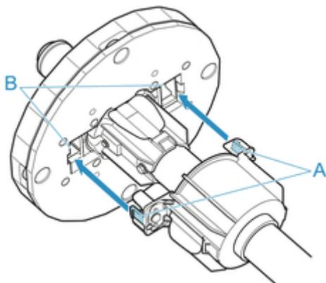
3. Setzen Sie mit nach vorne zeigender Vorderkante des Rollenpapiers (siehe Abbildung) den Rollenhalter an der rechten Seite in die Rolle ein. Setzen Sie die Rolle fest ein, bis das Rollenpapier den Flansch (A) des Rollenhalters berührt.
