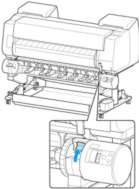
7. Halten Sie die Flansche (A) des Rollenhalters so, dass sich das schwarze Zahnrad an der linken Seite befindet, richten Sie die Welle des Rollenhalters links und rechts an den Führungsschlitzen der Rollenhalternut (B) aus und setzen Sie den Rollenhalter ein.
