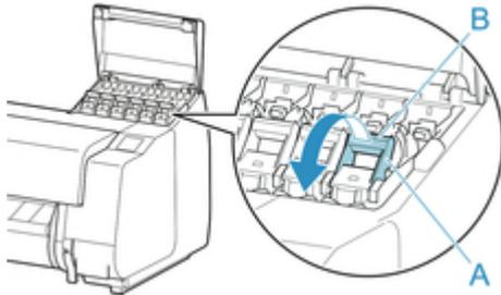
3. Ziehen Sie den Sperrhebel für den Tintenbehälter heraus.
