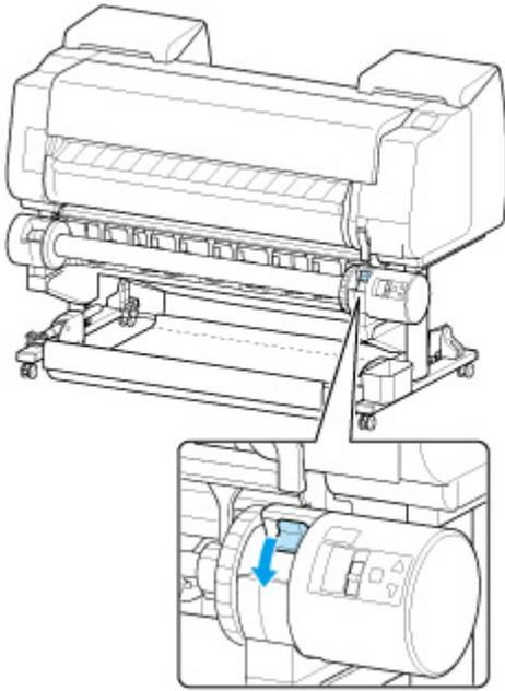
9. Stellen Sie den Schalter an der Zufuhrklappe oben auf der Rolleneinheit so ein, dass die Schalteranzeige (A) an der Position ● (B) des Aufnahmesymbols ausgerichtet ist.
