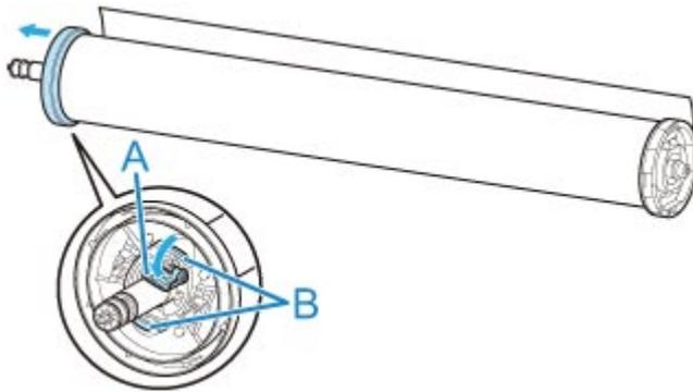
11. Entnehmen Sie das eingezogene bedruckte Material für jede Papierspule aus dem Rollenhalter.
