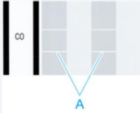
Wenn horizontale Linien blass oder unvollständig sind, führen Sie eine Reinigung des Druckkopfs durch.
