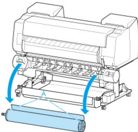
10. Entfernen Sie den Halteranschlag vom Rollenhalter.
