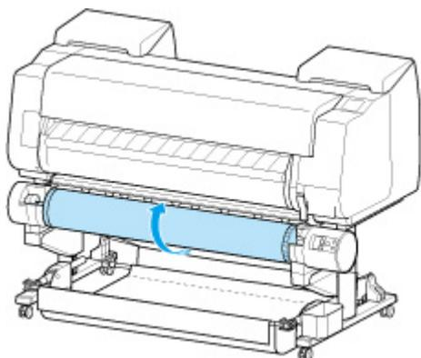
6. Stellen Sie den Schalter **Rollenhaltersperre** an der Rolleneinheit in die Entriegelungsposition.
