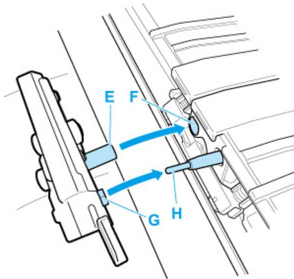
9. Richten Sie dabei das im Lieferumfang des neuen Schneidmessers enthaltene Befestigungselement an der Mitte des Schneidmesser aus.
