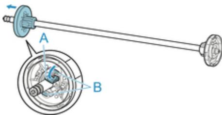
3. Wenn Rollenpapier aufgenommen wird, dessen Papierspule einen inneren Durchmesser von 76,2 mm (3 Zoll) hat, setzen Sie die 3-Zoll-Papierspulenaufhängung in den Rollenhalter und den Halteranschlag ein.
