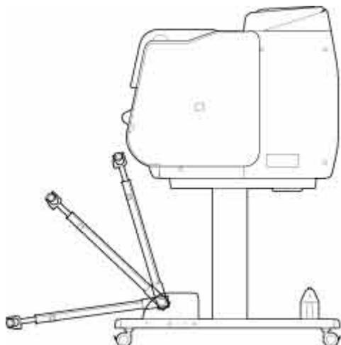
Bringen Sie beim Sichern des Korbarms die Korbverriegelungsstütze auf beiden Seiten an die Korbarme (A) an.
