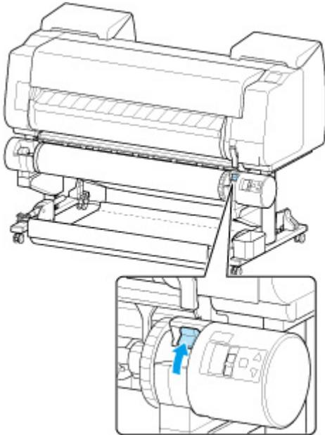
9. Halten Sie den Rollenhalter an den Flanschen (A), und entnehmen Sie ihn aus der Rolleneinheit.
