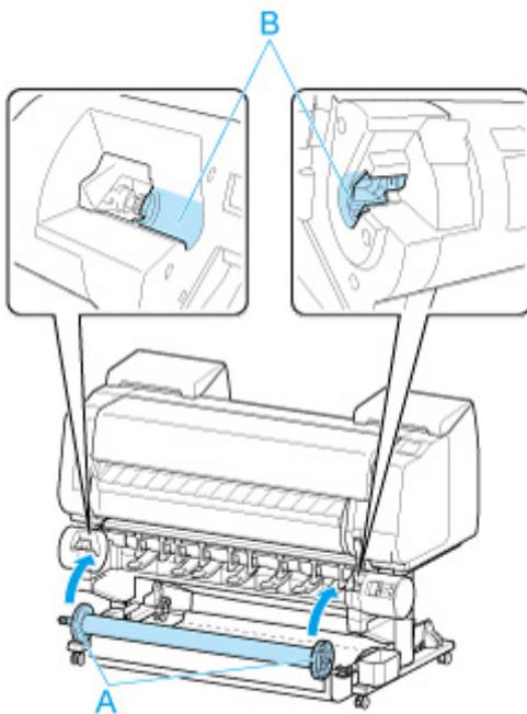
8. Stellen Sie den Schalter der **Rollenhaltersperre** an der Rolleneinheit in die verriegelte Position.
