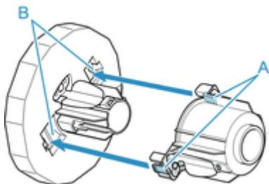
5. Setzen Sie den Halteranschlag in den Rollenhalter ein, und verriegeln Sie ihn dann, sodass er einrastet.
