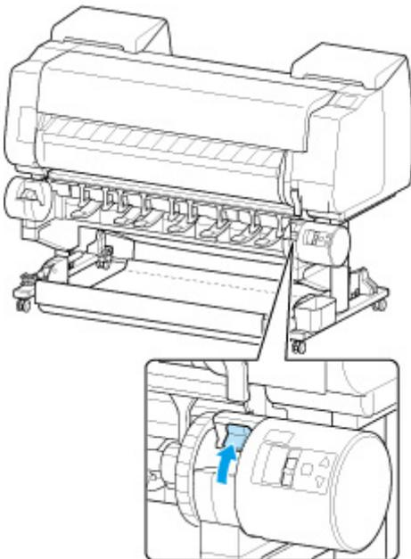
3. Halten Sie die Flansche (A) des Rollenhalters so, dass sich das schwarze Zahnrad an der linken Seite befindet, richten Sie die Welle des Rollenhalters links und rechts an den Führungsschlitzen der Rollenhalternut (B) aus und setzen Sie den Rollenhalter ein.
