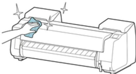
Öffnen Sie die obere Abdeckung und die Ausgabeführung und reinigen Sie die Komponenten (A, B), die mit Papier in Kontakt kommen, den Sensor (C) und das Fenster an der Rückseite der oberen Abdeckung.
