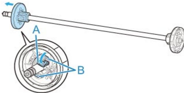
2. Wenn Sie Papier mit einer 3-Zoll-Spule verwenden, richten Sie die Laschen (A) der 3-Zoll-Papierspulen aufhängung an den Bohrungen (B) des Rollenhalters aus, und schieben Sie sie fest hinein.
