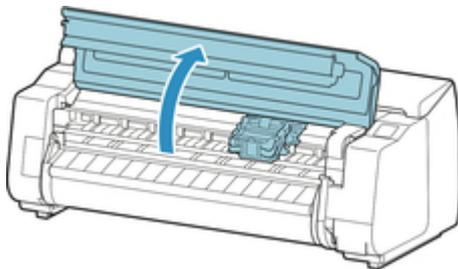
7. Wenn die Verriegelung für den Druckkopf und der Sperrhebel für den Druckkopf schmutzig sind, wischen Sie diese mit einem vollständig ausgewrungenen Tuch ab.
