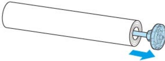
3. Zum Entfernen der 3-Zoll-Papierspulenabhängung drücken Sie die Laschen (A) nach innen, und entfernen Sie die Befestigung.
