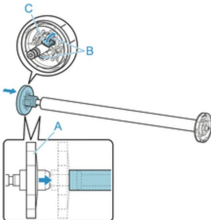
6. Stellen Sie den Schalter der **Rollenhaltersperre** an der Rolleneinheit in die Entriegelungsposition.
