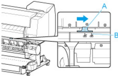
10. Stellen Sie den Schalter zum **Umschalten zwischen Einziehen nach innen/außen** an der Rolleneinheit auf die gewünschte Spulrichtung.
