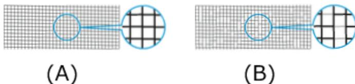
(A) Solange die horizontalen Linien gerade sind und gedruckt werden, funktioniert die Düse ordnungsgemäß.
