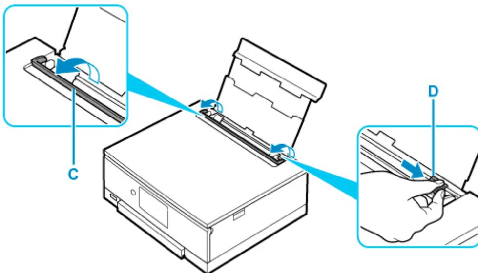
5. 封筒の印刷したい面を表にして、封筒を縦にセットする
