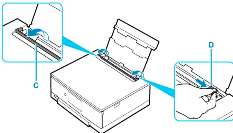
5. 印刷したい面を表にして、用紙を縦にセットする
