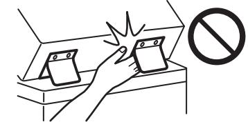
カセットを引き抜いた状態で、本体内部に手を入れない(カセット装着機のみ)
