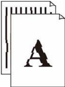
Les lignes sont mal alignées/déformées
