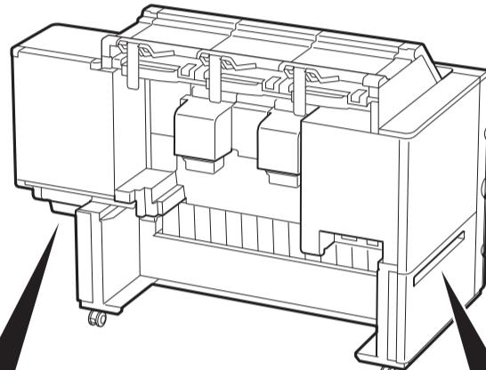
**2** Demandez à 4 personnes de saisir les poignées de transport sur le côté gauche de l'imprimante et de soulever doucement le côté gauche. Retirez le matériau d'emballage inférieur dans le sens de la flèche.
