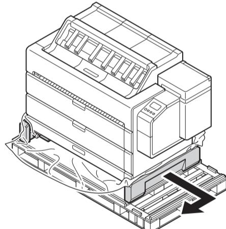
**2** Solicite a 4 personas que agarren las asas de transporte del lado izquierdo de la impresora y que levanten con cuidado el lado izquierdo. Retire el material de embalaje inferior en la dirección de la flecha.
