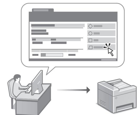
L'IU distante permet de gérer la machine à l'aide du navigateur Web d'un ordinateur. Vous pouvez l'utiliser pour vérifier l'état de fonctionnement de la machine, modifier les paramètres et enregistrer des éléments dans le carnet d'adresses.
