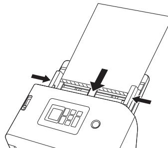
原稿をセットしたら、原稿ガイドを原稿の両端に合わせてください。
