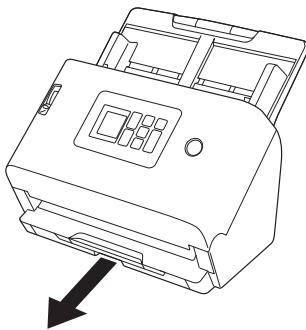
排紙トレイは3段階の長さ調節が可能です。原稿の長さに合わせて排紙トレイを引き出してください。また、必要に応じて先端の排紙ストップバーを立ててください。
