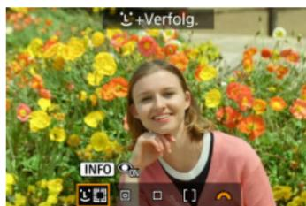
Die Kamera erkennt menschliche Gesichter und stellt darauf scharf. Über jedem erkannten Gesicht wird ein AF-Messfeld angezeigt [ $\text{AF}^+$ ], das dann verfolgt wird. Wenn kein Gesicht erkannt wurde, wird der gesamte AF-Bereich für die Fokussierung verwendet.
